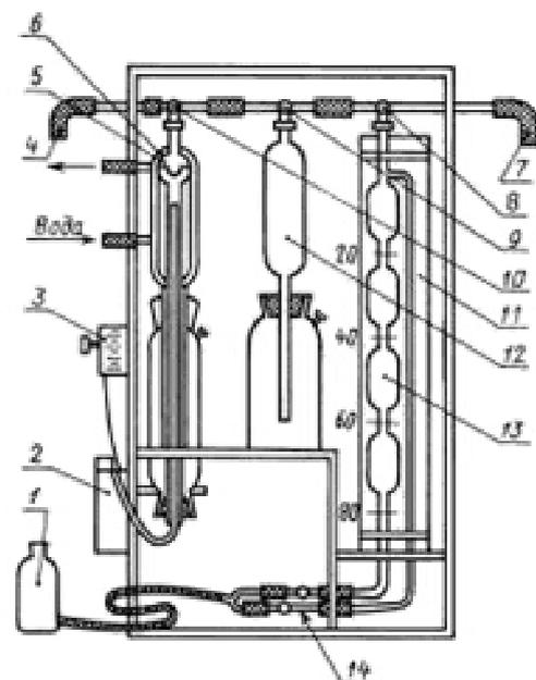
1 — уравнивающая склянка; 2 — трансформатор на 60 Вт (первичная обмотка на 220 В, вторичная на 2—3 В); 3 — реостат на 3—5 Ом, 5—6 А; 4, 7 — резиновые трубки; 5 — спираль из платиновой проволоки диаметром 0,3 мм, длиной 60 мм; 6 — сжигательная пипетка с водяным охлаждением; 8, 9, 10 — краны распределительной гребенки; 11 — водяная рубашка; 12 — поглотительный сосуд; 13 — измерительная бюретка; 14 — переходник
